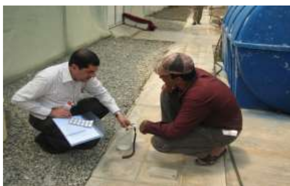
شکل ۷- تهیه نمونه‌های موردنیاز در ظروف مخصوص جهت ارسال به آزمایشگاه
