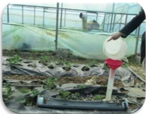
شکل ۲- نحوه‌ی برآورد درصد خطای اندازه‌گیری دبی آبیاری قطره‌ای نواری
