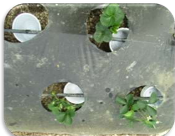
شکل ۱- نحوه‌ی برآورد درصد خطای اندازه‌گیری دبی لوله‌های قطره‌چکان دار
