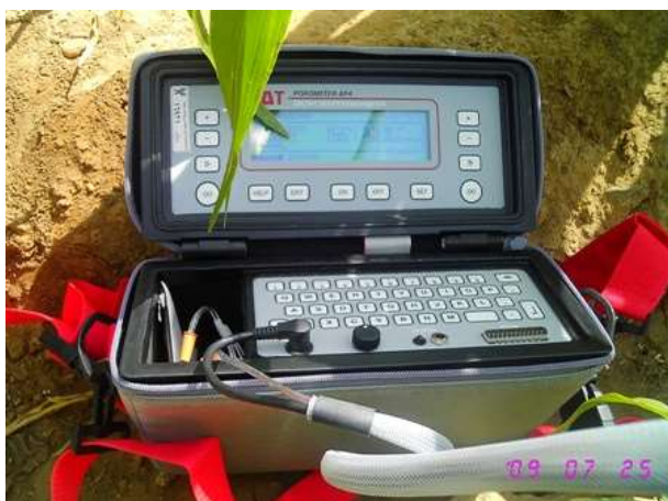
شکل ۲- اندازه‌گیری هدایت روزنه‌ای در مزرعه با دستگاه پورومتر
