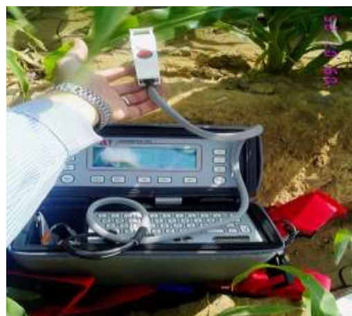
شکل ۲- اندازه‌گیری هدایت روزنه‌ای در مزرعه با دستگاه پورومتر
