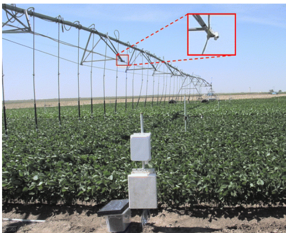
شکل ۵- دماسنج های مادون قرمز نصب شده روی سامانه سنتریپوت (Peters & Evett, 2008)
