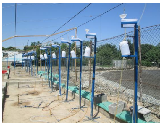
شکل ۶- نمای دستگاه تک واحده اندازه‌گیری تراوش گسیلنده سفالی در شرایط صحرائی به روش نقطه‌ای
