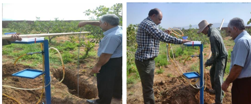
شکل ۷- اندازه گیری تراوش سفال مدفون در خاک در باغ پسته مجهز به سامانه آبیاری زیرسطحی سفالی در منطقه کرمان (روش اندازه گیری خطی Line source)
