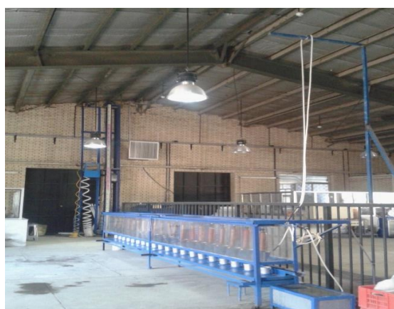
شکل ۵- نمای کلی دستگاه ۲۰ واحده در حال اندازه‌گیری تراوش گسیلنده‌ها در آزمایشگاه فنی و مهندسی
