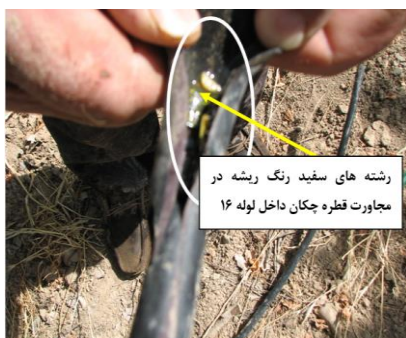
شکل ۴- رشته‌های سفیدرنگ ریشه در داخل لوله ۱۶ میلی‌متر در آبیاری قطره‌ای زیرسطحی
