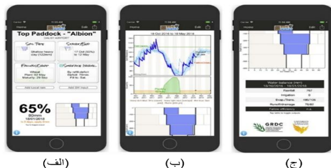
شکل ۴ - نمونه‌ای از رابط کاربری Soil Water App؛ (الف) گزینه‌های ورودی و خروجی؛ (ب) رطوبت خاک و (ج) مشخصات رطوبت خاک و جدول بیان آب
