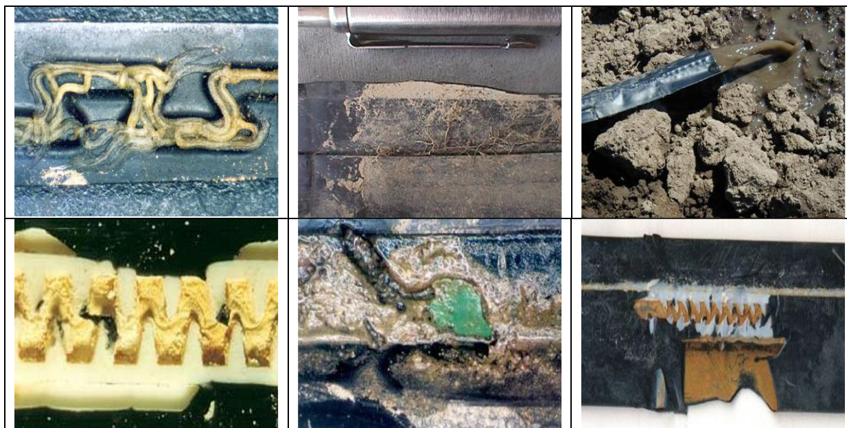
شکل ۴- انواع مختلف گرفتگی در نوارهای تیپ (Burt, 2008)
