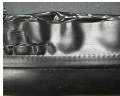
شکل ۳- آسیب دیدگی نوارهای تیپ در اثر فشار اضافی (Burt, 2008)
