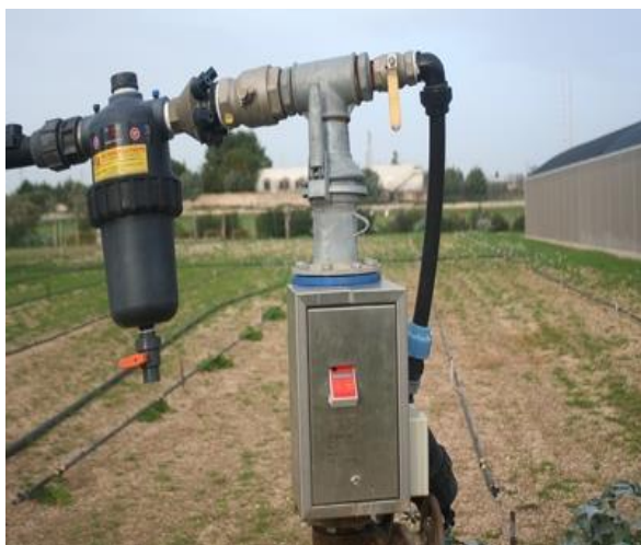
شکل ۱- نمونه پایش اطلاعات مزرعه‌ای برای مدیریت ایستگاه پمپاژ با قابلیت کارکرد به صورت تعاملی (Bari- Italy).
