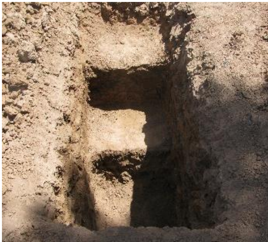
شکل ۱- حفر پروفیل برای برداشت نمونه دست‌نخورده خاک از لایه‌های مختلف ۳۰ سانتی‌متری تا حداکثر عمق ۱۲۰ سانتی‌متری
