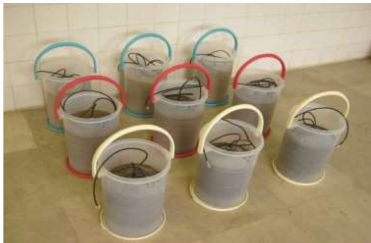
شکل ۲- ظروف پرشده از خاک به همراه حسگر نصب‌شده و نحوه اشباع خاک داخل آن‌ها
