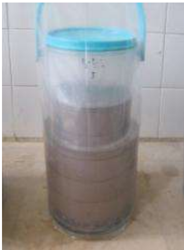
شکل ۲- ظروف پرشده از خاک به همراه حسگر نصب‌شده و نحوه اشباع خاک داخل آن‌ها
