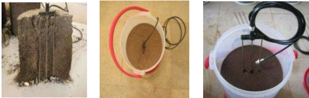
شکل ۳- مراحل نصب حسگر دفنی در خاک
