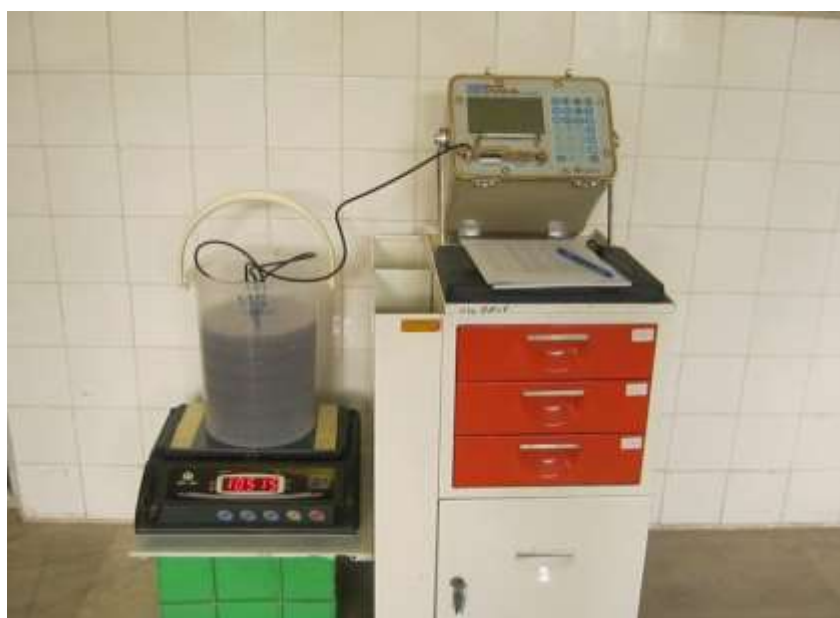
شکل ۴- اندازه‌گیری همزمان رطوبت خاک به روش TDR و وزنی
