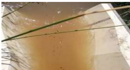
شکل ۱- تعیین دبی کانال با فلوم WSC در کانال گندجین
