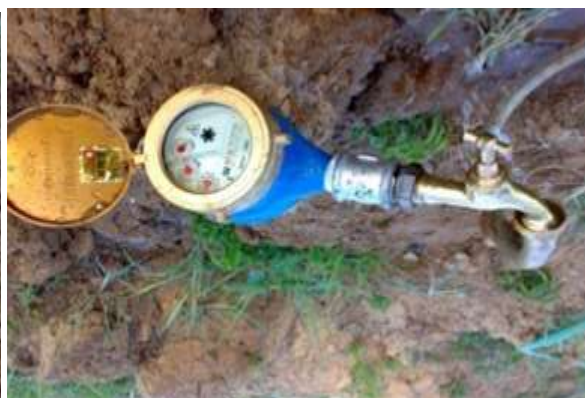
شکل ۱- آبیاری به روش کرتی و اندازه‌گیری حجم آبیاری به‌وسیله کنتور حجمی
