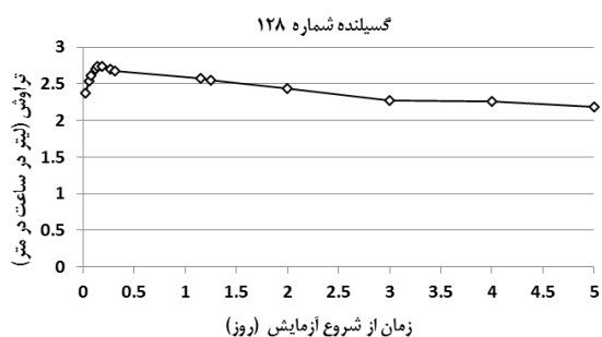
شکل ۱۰- تغییرات زمانی تراوش از یک گسیلنده در فشار هیدرو استاتیک ۱ متر
