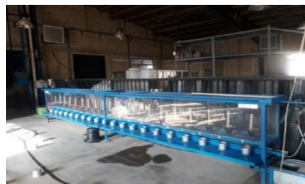
شکل ۲- نمای کلی دستگاه ۲۰ واحدی در حال اندازه‌گیری تراوش گسیلنده‌ها در آزمایشگاه فنی و مهندسی
